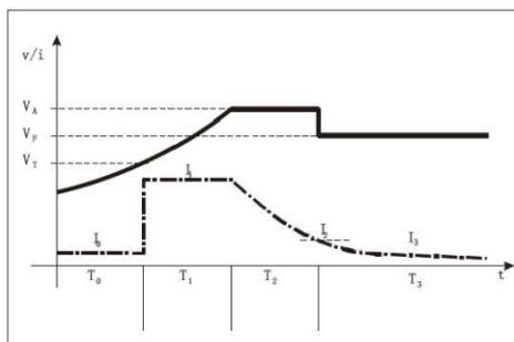
$V_A=2,4$  В/эл,  $V_F=2,3$  В/эл,  $I_1=0,2C$ ,  $I_2=15-30\%I_1$
