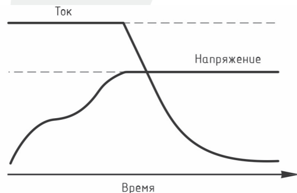
Рис. 1 - Зависимость тока и напряжения от времени при заряде по методу IU
