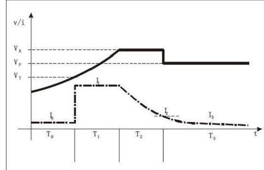
$V_A=2,4$  В/эл,  $V_F=2,3$  В/эл,  $I_1=0,2C$ ,  $I_2=15-30\%I_1$
